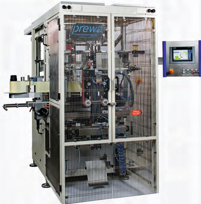
Die High End Schlauchbeutelmaschine von **prema Verpackungsmaschinenbau** zeichnet sich durch ein robustes Maschinengehäuse und einer modularen Bauweise aus. Der massive Rahmen dieser Maschine in lackierter Ausführung (optional in Edelstahl) sorgt, in Verbindung mit qualitativ hochwertigen mechanischen und elektronischen Komponenten, für eine hohe Ausbringung und Maschinenverfügbarkeit.
