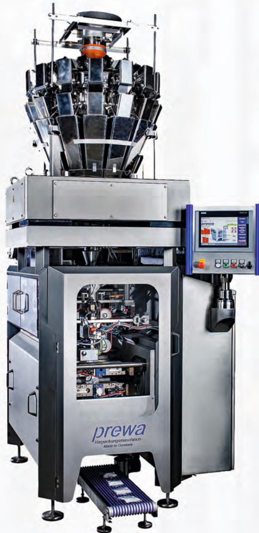
Der Maschinentyp „RotoTwin 250“ deckt den Hochleistungsbereich bis 200 Beutel pro Minute, bei einer maximalen Beutelbreite bis 250mm, ab. Die innovative Bauweise in Verbindung mit der Auswahl an qualitativ hochwertigen mechanischen und elektronischen Komponenten garantiert eine sehr hohe Ausbringung und Maschinenverfügbarkeit.
